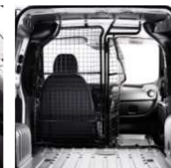
Modulares Trenngitter in Verbindung mit dem modularen Beifahrersitz erhältlich.
