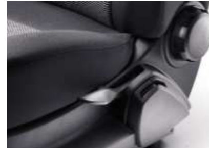
Höhenverstellbarer Fahrersitz mit Lordosenstütze*
