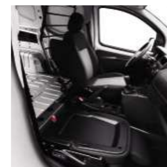
Modularer Beifahrersitz (versenkt), der zusätzlichen Platz zur Verfügung stellt.
