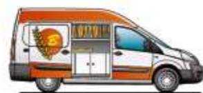
Marktwagen auf Basis des geschlossenen Kastenwagens mit Kühlung
